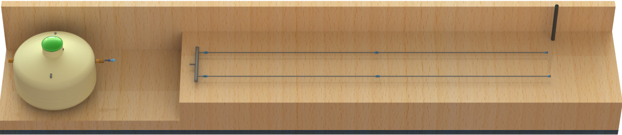
Eksempel 1 Trykkinfiltrasjonsanlegg: Bestående av Baga slamavskiller m/ integrert støtbelaster, manifold og infiltrasjonsrør (i bakken)
