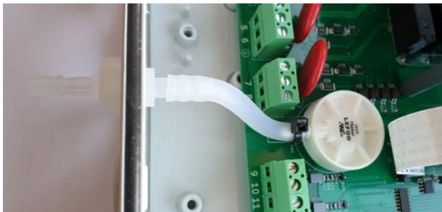
Figur 5 - Slangen koblet til trykkbryteren
