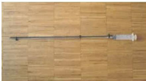
60 ml Kanyle med sugeslange og styrepinne
